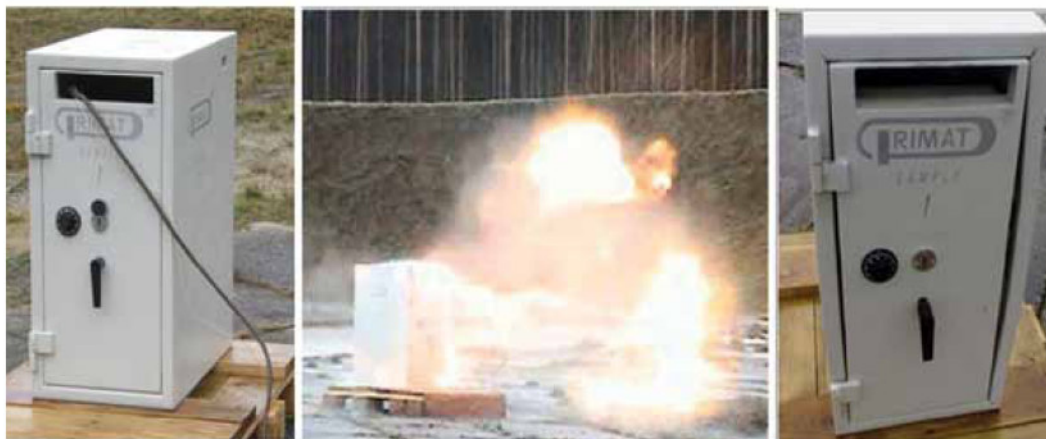
a) Bankomatna blagajna pred eksplozijo b) Bankomatna blagajna med eksplozijo c) Bankomatna blagajna po eksploziji
